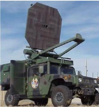
Questo dispositivo è in grado di indirizzare (“sparare”) un fascio di microonde ad alta energia verso un bersaglio preciso. La frequenza utilizzata si aggira intorno ai 95 Ghz. Il “raggio del dolore” è classificato come “arma non letali”, in quanto il suo raggio invisibile penetra sotto la pelle soltanto per alcuni millimetri, facendo temporaneamente impazzire i recettori del dolore. Nel giro di 1 – 2 secondi chi viene colpito dal raggio a microonde prova la sensazione di andare a fuoco.
