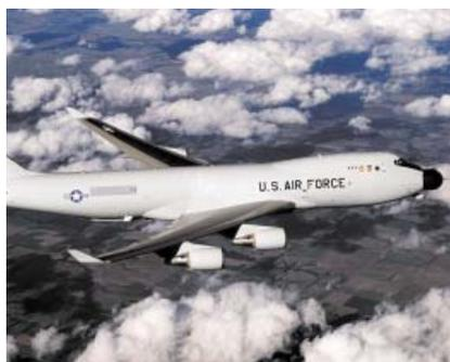
Il sistema ABL consiste in un laser chimico ad alta energia (Chemical Oxygen Iodine Laser - COIL), montato su di un Boeing 747 modificato. Il dispositivo, sviluppato dalla Northrop Grumman e dalla Boeing è in dotazione all'aeronautica USA dal 2003. L'ABL è in grado di individuare ed abbattere missili balistici, può restare in quota per molte ore e rifornirsi di carburante mentre è in volo.
